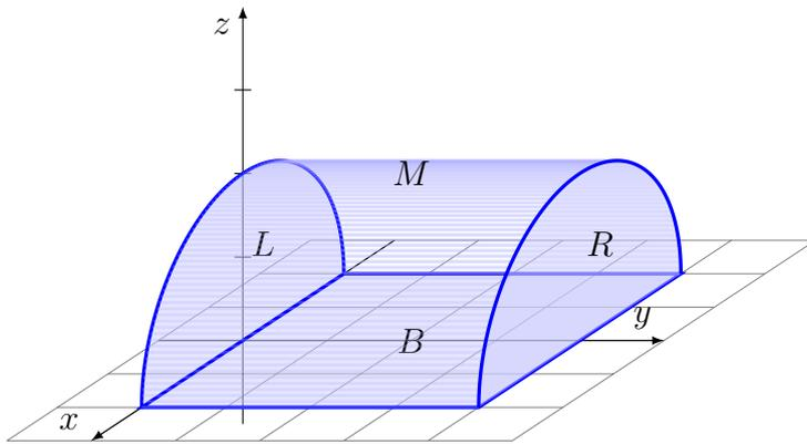
$$\begin{pmatrix} x \\ y \\ z \end{pmatrix} = \Phi \begin{pmatrix} \rho \\ \varphi \\ y \end{pmatrix} = \begin{pmatrix} \rho \cos \varphi \\ y \\ \rho \sin \varphi \end{pmatrix}$$
